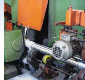
Nass-Centerless-Schleifen für Oberflächenendbearbeitung von Rohren.
