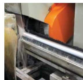
Um eine sehr feine Oberfläche (unter 0,5 µm) und einen Spiegeleffekt zu erhalten verwenden Sie Kork/Siliciumcarbid-Schleifbänder in den Körnungen P400 bis P800 und anschließend reine Korksleifbänder.
