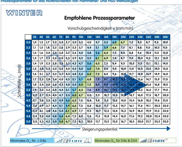
Die angegebenen Vorschubempfehlungen sind Richtwerte und gelten sowohl für Diamant- als auch für cBN-Werkzeuge. Bei kleinen Werkstückdurchmessern, extremen Nutbreiten oder bei Schleifscheiben unterhalb 100 mm Durchmesser müssen
